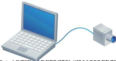
최대 400 Mbytes/s의 데이터 속도 및 전원을 제공하는 USB 3.0 포트로 단일 케이블로 연결된 카메라 프레임 그래버 필요 없음
