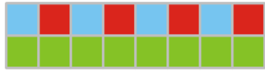
적색과 청색이 교대로 있고 녹색이 있는 필터를 가진 Bilinear 센서 픽셀
