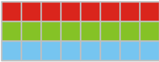
라인당 적색, 녹색, 청색 필터를 가진 Trilinear 센서 픽셀
