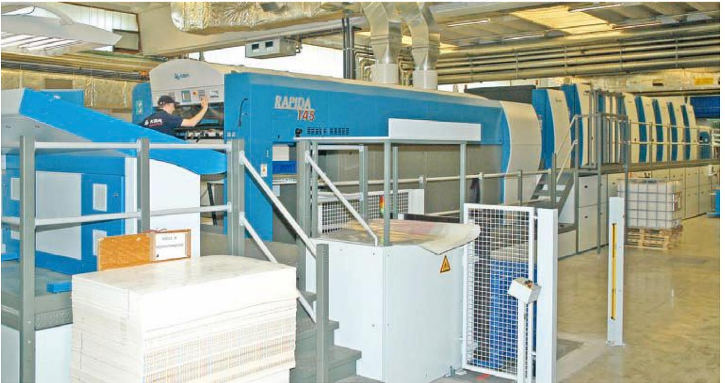
그림 8. 독일의 뷔르프부르크에 위치한 KOENIG & BAUER AG 가 개발한 RAPIDA 145 Press 는 인라인에서 컬러 강도를 측정하고 제어하는 QUALTRONIC COLORCONTROL 장치에서 PIRANHA COLOR 4K 카메라를 사용합니다.
